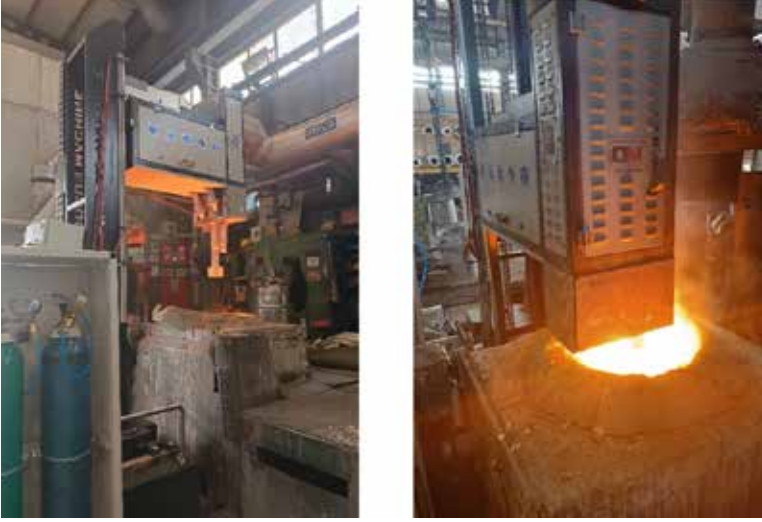
Şekil 1: (a) Gaz Alma işlemi öncesi rotor-şaft ve dalgakıranın indüksiyon ocakları üzerinde ön ısıtma işlemi (b) indüksiyon ocağında bakır alaşımı içerisinde gaz alma ve cüruf giderme makinesi ile gerçekleştirilen tam otomasyon kontrollü gaz alma işlemi
