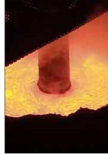
Şekil 2: Bakır alaşımlarında gaz alma işlemi sırasında vorteks oluşumu
