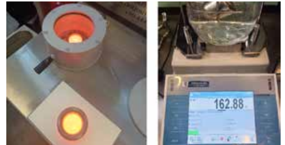
Şekil 3: (a) İncelenen bakır alaşımlarının vakum yoğunluk testi (b) atmosferik koşullarda ve vakum basıncı altında katılaştırılan numunelerin yoğunluk ölçüm ünitesi ile yoğunluk indeks değerlerinin belirlenmesi
